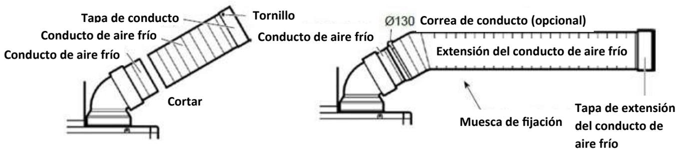
• **Fijación de la extensión del conducto de aire frío a un conducto de aire frío cortado**
